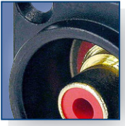
Vergoldete Cinch Einbaubuchse
